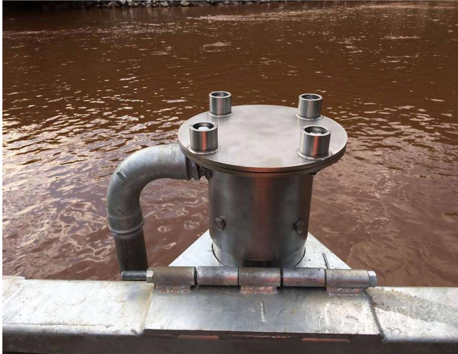
Figura 9: Exemplo de proteção anti-vandalismo do parafuso antifurto. A proteção ao redor do parafuso deverá impedir o uso de alicates
