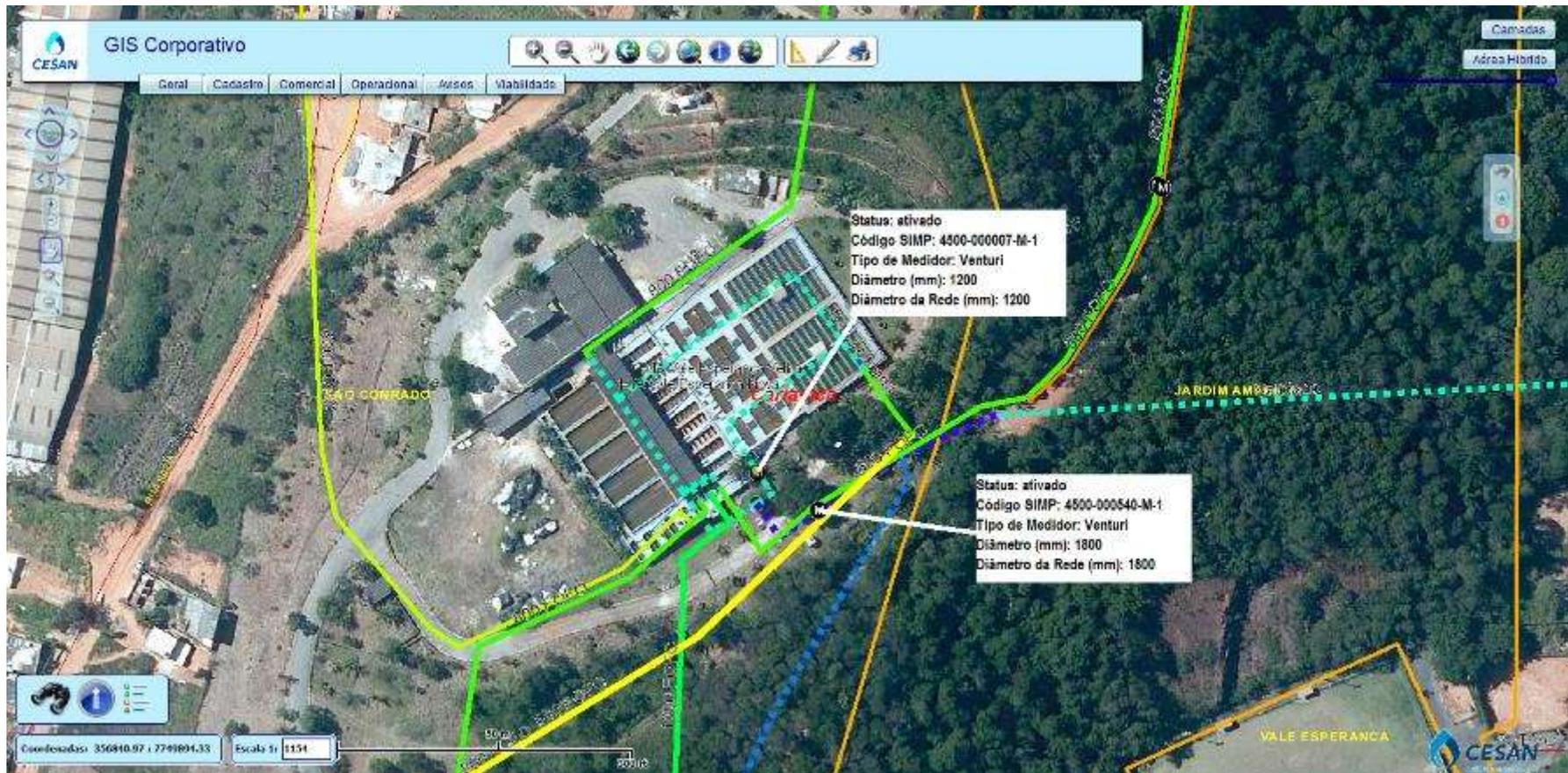
Figura 20 -Sistema do Rio Jucu – ETA I (Vale Esperança). Posicionamento das Adutoras, macromedidores e diâmetros.
