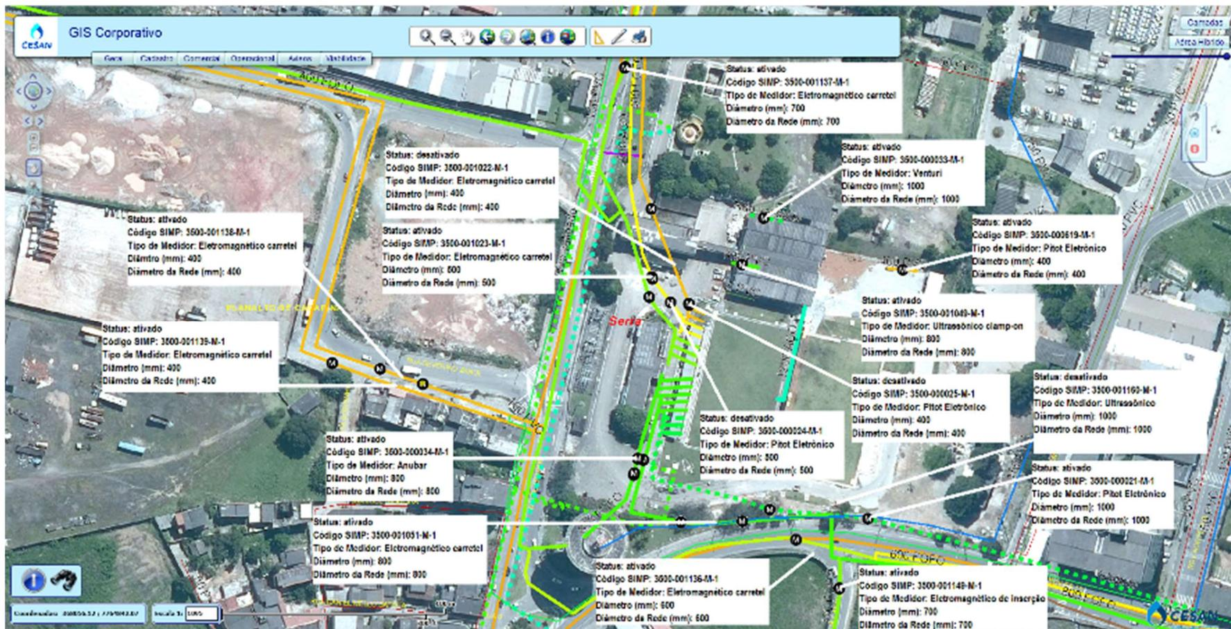
Figura 29 - Sistema do Rio Santa Maria – ETA V, EEAT e EEAB de Planalto. Posicionamento das Adutoras, macromedidores e diâmetros.
